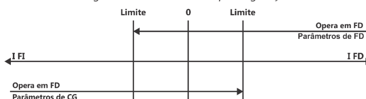
Figura 36 - Fluxo inversor por cogeração
